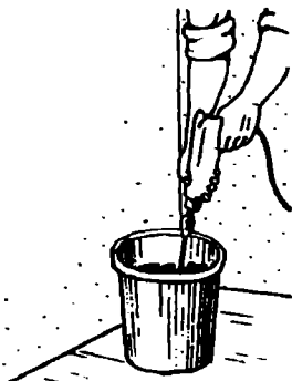
Приготовление клеевого раствора
