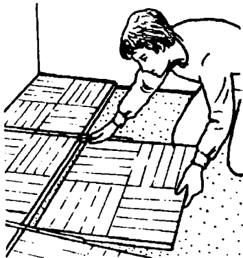
Раскладка щитов «насухо»
