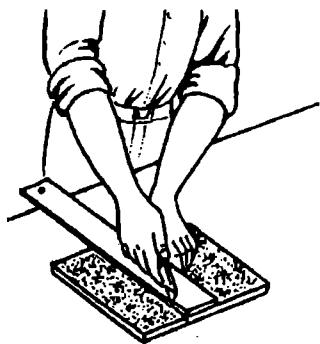
Линию отреза фиксируют стальной линейкой
