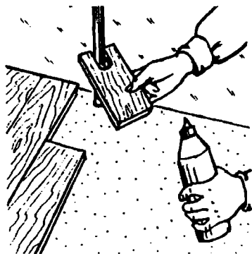
Проклеивание паза и выступа соседних досок
