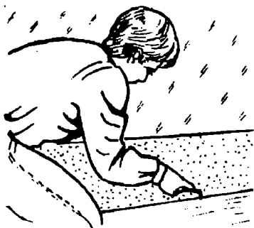
Формирование канавки для шнура
